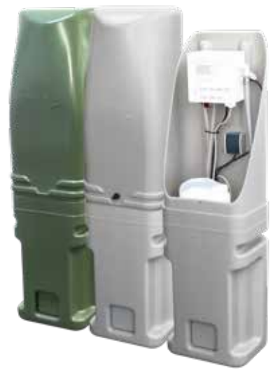
Optional: Freiluftssäule X7 (B x H x T: 422 x 1510 x 316 mm) Art.-Nr. 101932 - Grau Art.-Nr. 101960 - Grün (ohne Verdichter + Steuerung) Freiluftssäule einsetzbar bis 20 EW Weitere Freiluftssäulen / Aufstellvarianten finden Sie im Kapitel "Freiluftssäulen".
